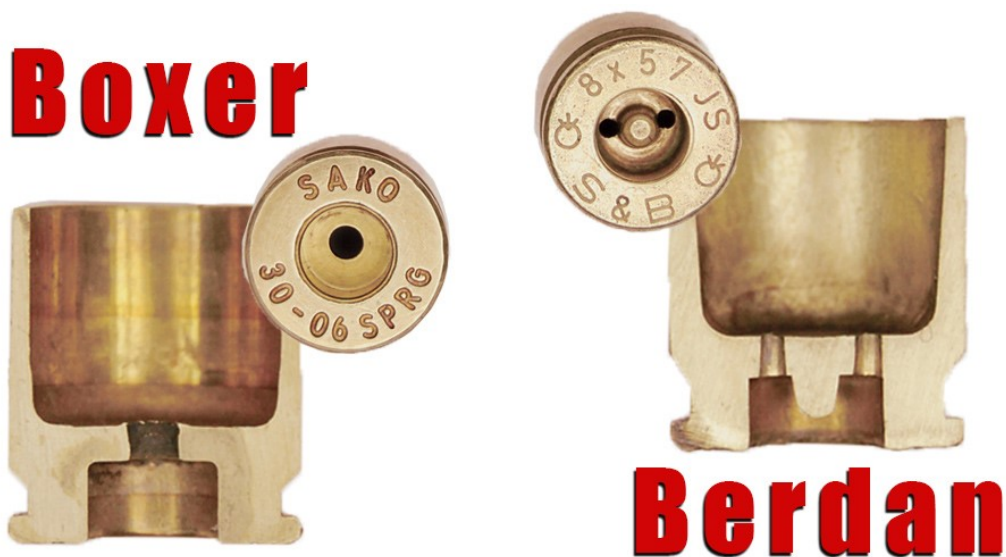
Obr. 2.11 Podélný řez nábojnicemi pro zápalky typu Boxer a Berdan [36]
