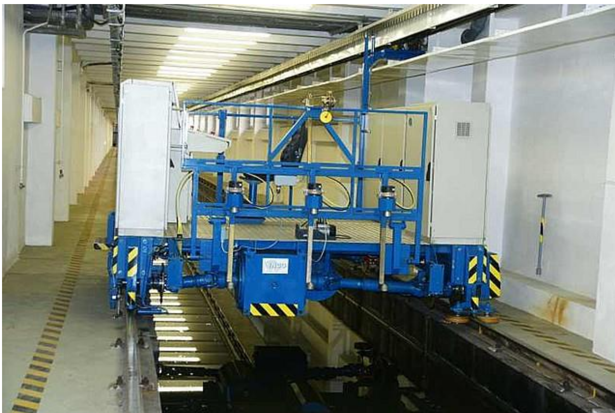
Obrázek č. 14: Kalibrační kanál a pojezdový vozík vodoměrných vrtulí [15]
