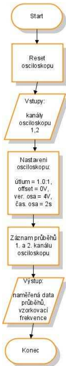
Obrázek 5.9: Vývojový diagram bloku NewInstrument (@oscilloscope)
