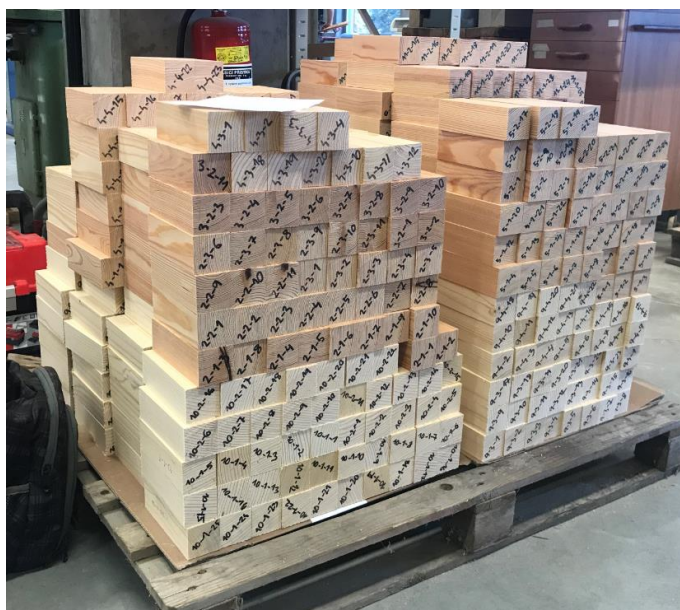
Obr. 30 Popsané zkušební tělesa o rozměrech 50 x 50 x 150 mm
