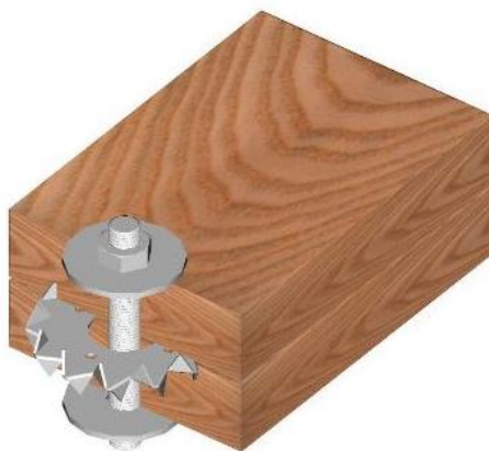
Obr. 20 Hmoždíkový spoj (BOVA Březnice spol. s r.o. 2020)
