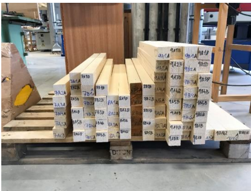
Obr. 28 Popsané a zkrácené latě o rozměrech 50 x 50 x 1000 mm
