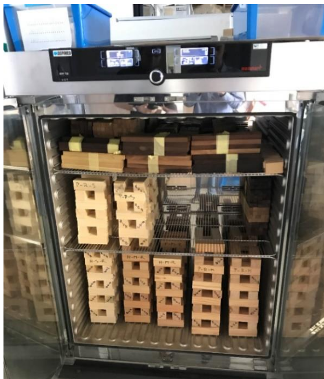
Obr. 33 Tělesa v klimatizační komoře
