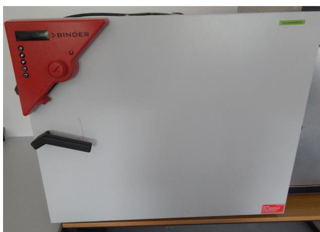
Obr. 35 Sušárna Binder (ČZU 2020)
