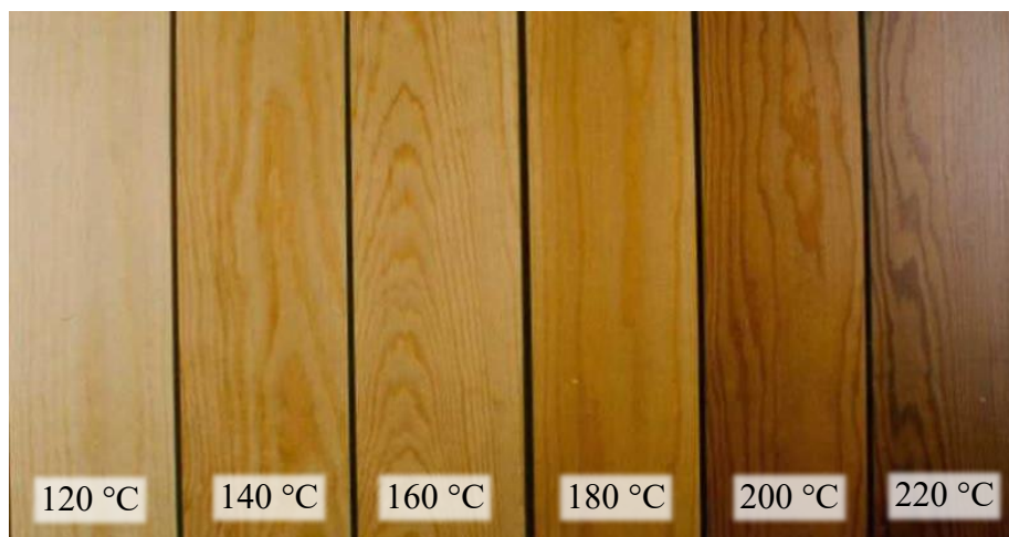
Obrázek 5: Barevné změny při různých teplotách úpravy metodou ThermoWood (ITA 2003)
