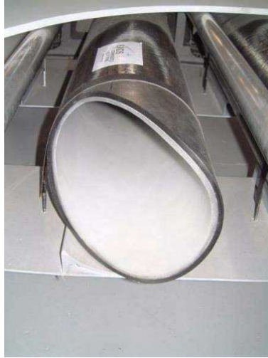
Obr. 4-6 [8]: Nádrž na stlačený vzduch
