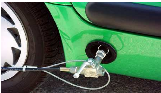
Obr. 4-10 [12]: Plnění na kompresní stanici
