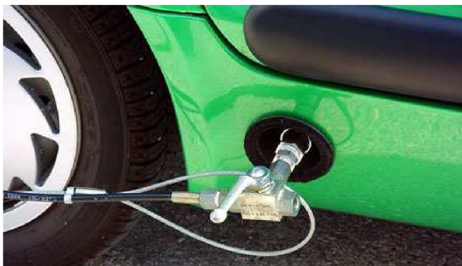
Obr. 4-10 [12]: Plnění na kompresní stanici
