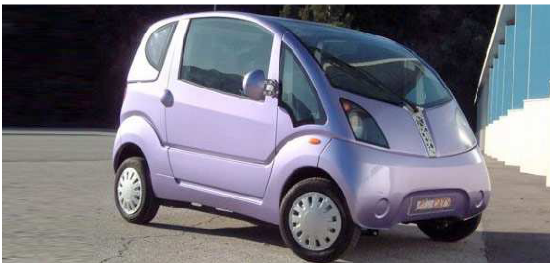
Obr. 4-11 [11]: Auto na stlačený vzduch
