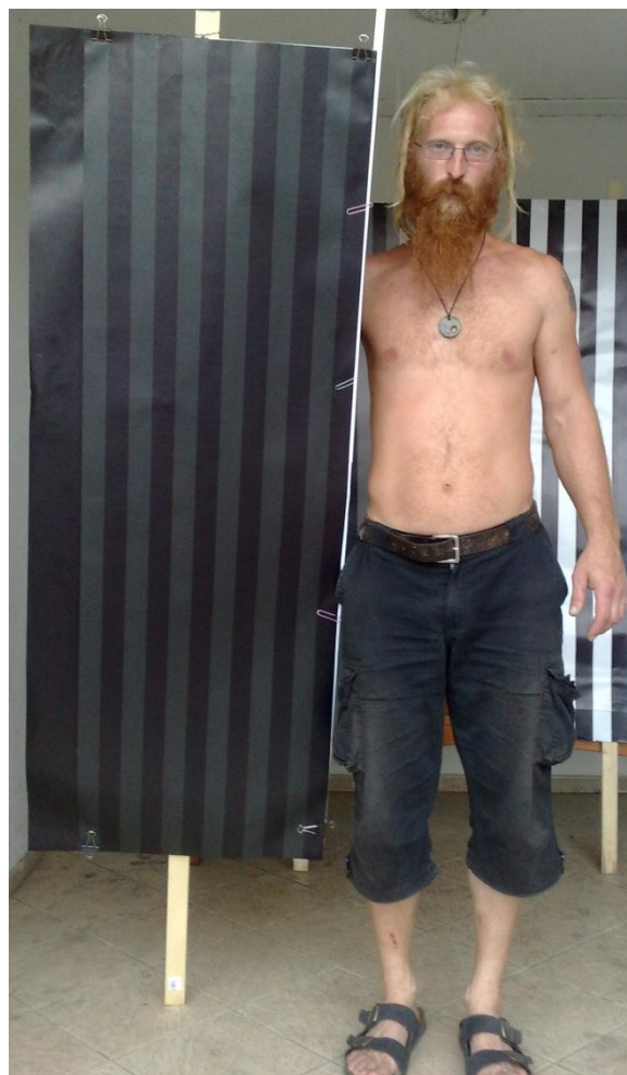
Obrázek 30: 6 čárový test o kontrastu K= 0,2
