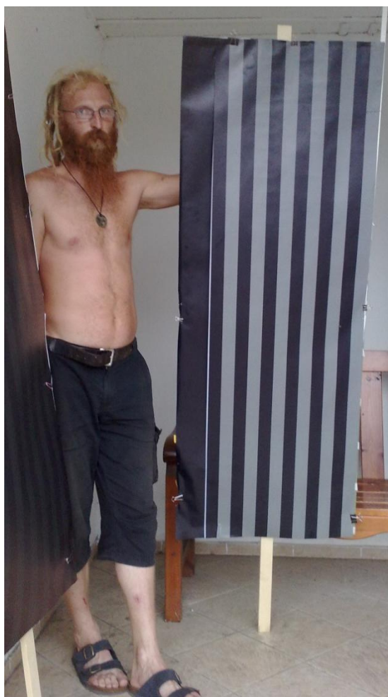
Obrázek 29: 6 čárový test o kontrastu K= 0,5
