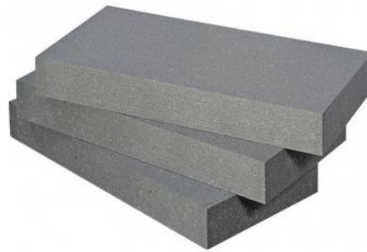
Obr. 1.3 EPS – Šedý polystyrén Neopor [13]
