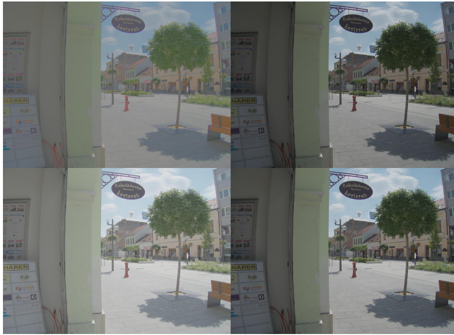
Obrázek C.4: Porovnanie dopadu vstupných parametrov na výsledok. Operátor Reinhard, snímok Námestie, (z ľavého horného rohu) a) f' = 0, a = 1, c = 0, \gamma = 2.2 , b) f' = -0.8, a = 0, c = 0, \gamma = 2.2 , c) f' = 0, a = 0, c = 0, \gamma = 3.5 , d) f' = 0, a = 0, c = 1, \gamma = 2.2
