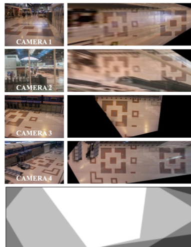
Obr. 6.1: Ukázka homografické transformace a mapy kamerového snímání[9]
