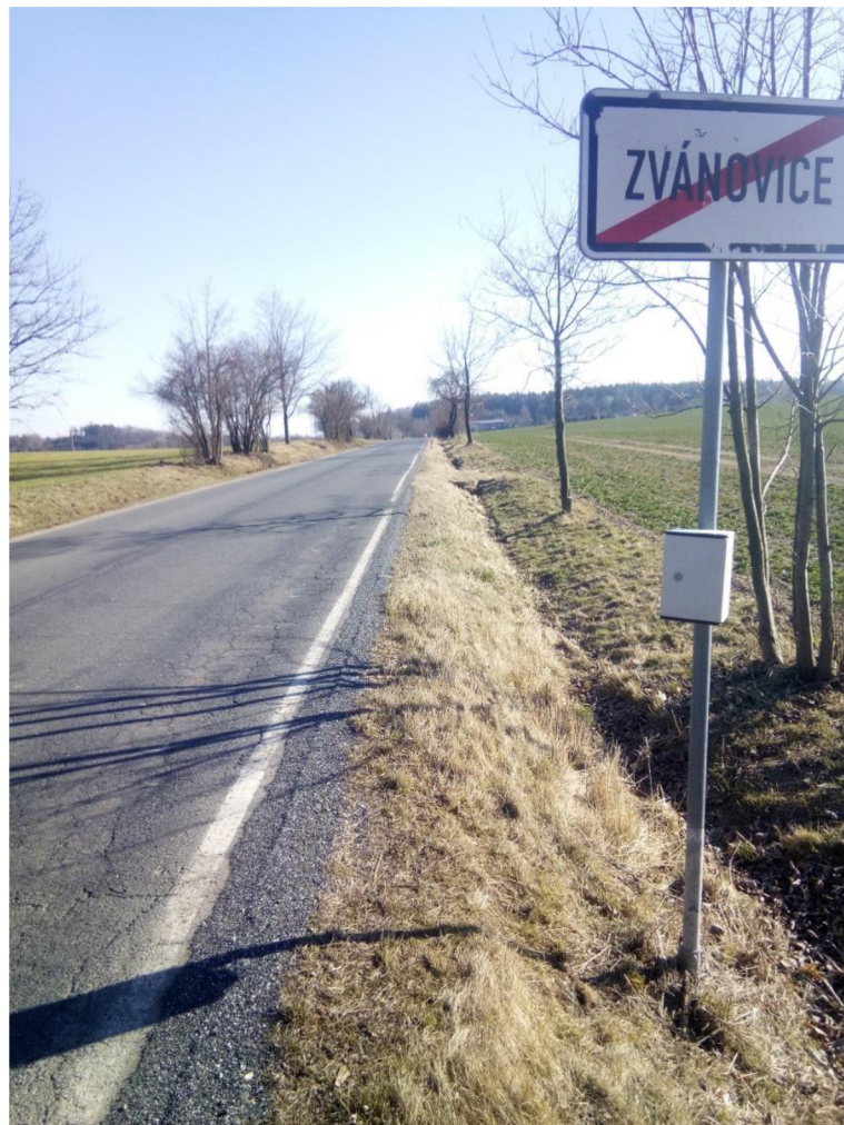
Obrázek 9 Sierzega radar u silnice (zdroj: vlastní)
