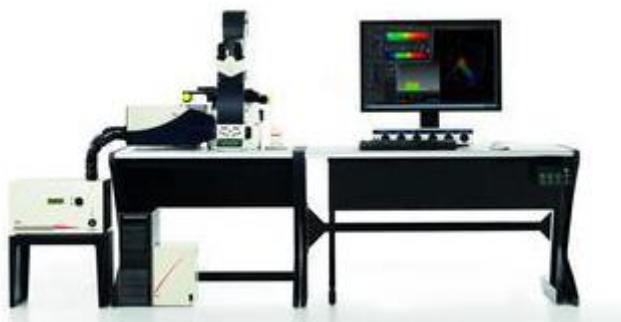
Obrázek 2.12: konfokální mikroskop Leica TCS SP8 s vybavením
