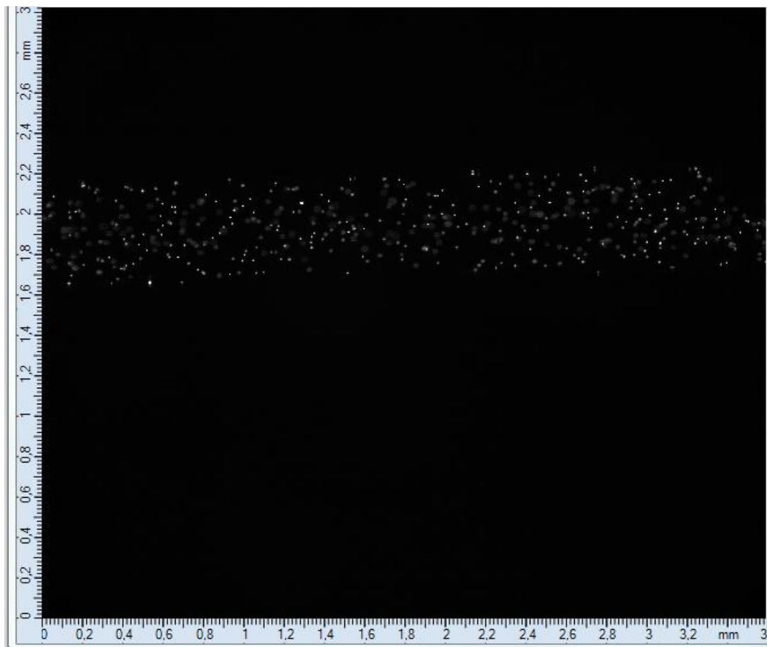
Obr. 24: Zobrazení sytících částic v průběžném kanálku
