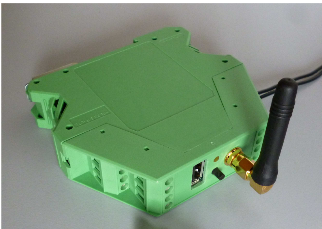
Obr. C.3: Pohľad na dokončené zariadenie v krabičke
