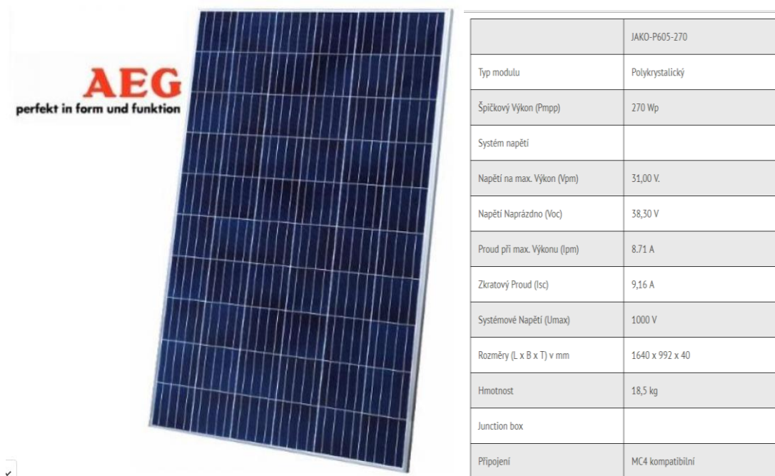
Obrázek 19 Solární panel a jeho specifikace
