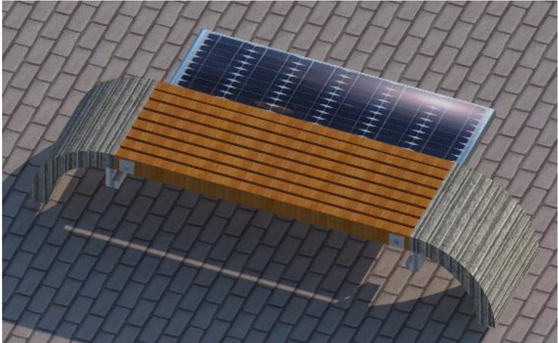
Obrázek 36 Renderovaný pohled na chytrou lavičku z masivního modřínové dřeva (návrh číslo2)
