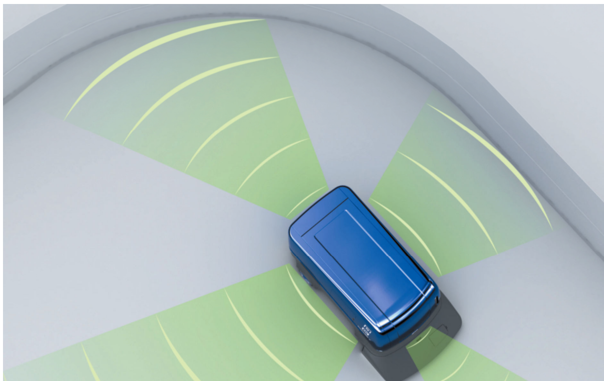
6.2 Ultrazvukové mapovanie priestoru
