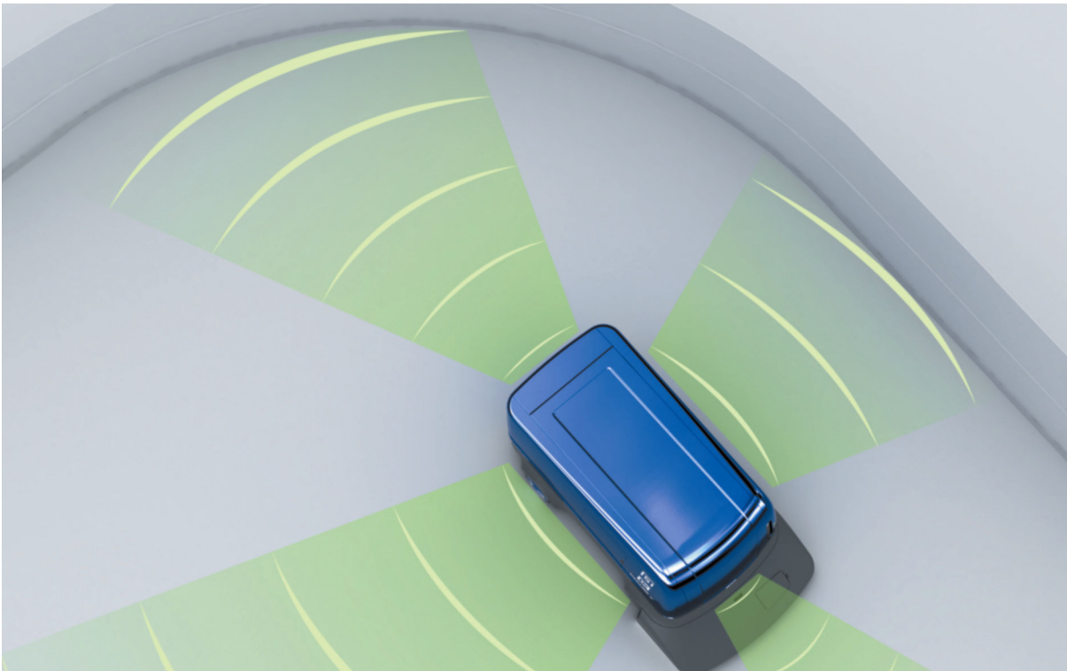
6.2 Ultrazvukové mapovanie priestoru
