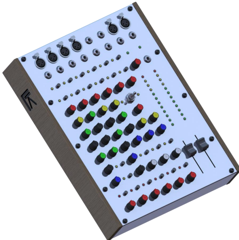
Obr. 3.5: Výsledná podoba návrhu šasi včetně ovládacích prvků.
