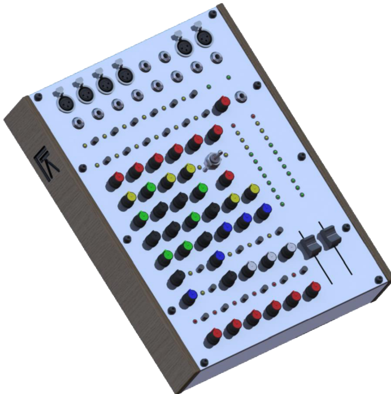
Obr. 3.5: Výsledná podoba návrhu šasi včetně ovládacích prvků.
