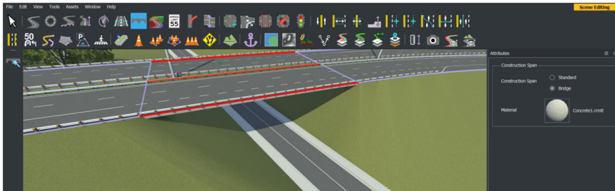
Obrázek 31 - Roadrunner: vytvoření mostu
