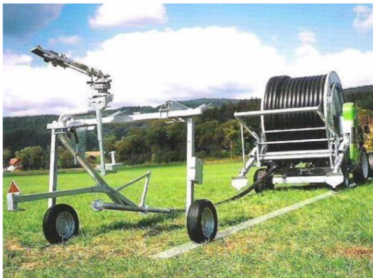
Obrázek 4 - Pásový zavlažovač (HYÁNKOVÁ, Eva. Závlahy 2. přednáška: Doplnková voda. )
