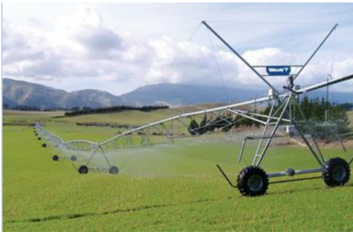
Obrázek 2 - Potrubí na podvozcích s lineárním pohybem (HYÁNKOVÁ, Eva. Závlahy 3. přednáška: Závlaha zemědělských ploch postřikem.)
