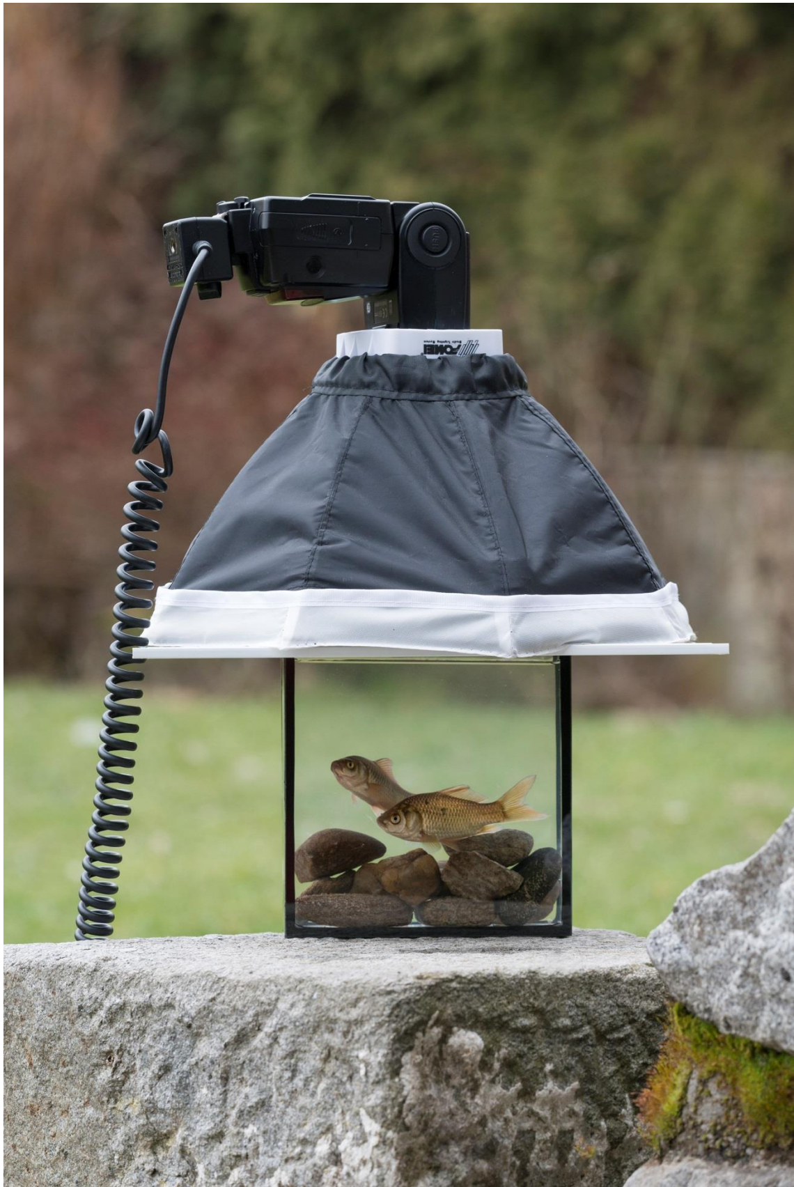
Obr. 13: Umístění blesku a postavení kyvety při práci v přírodě mimo ateliér
