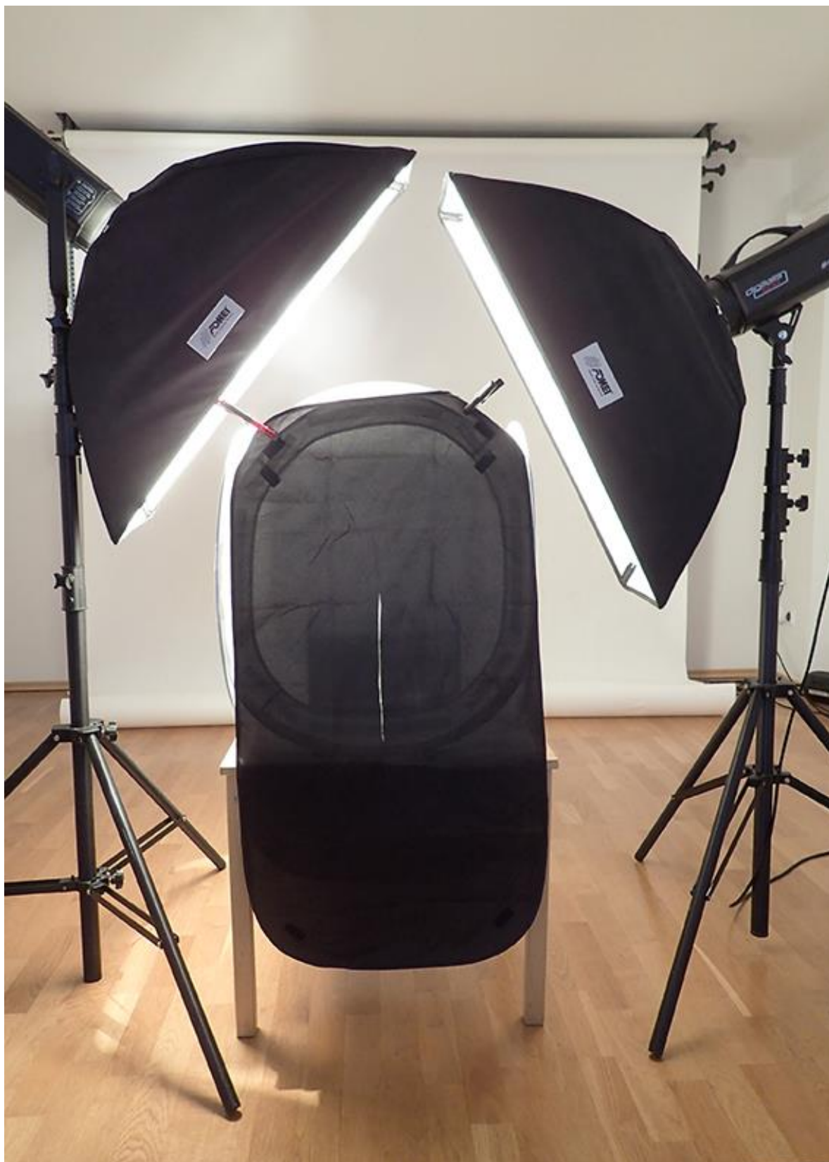
Obr. 23: Textilní antireflexní štít použitý před fotografickým stanem, v němž je umístěná kyveta
