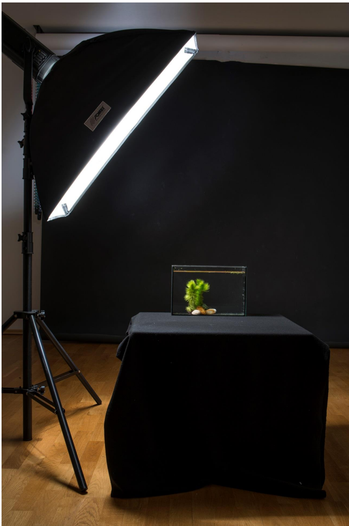
Obr. 6: Umístění zábleskového světla pro fotografie typu izolace na černém pozadí
