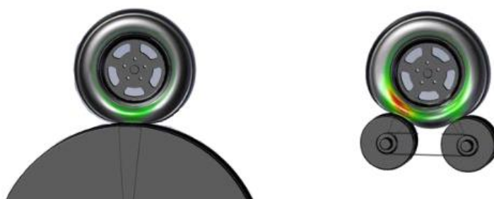
Obr. 18 Deformace pneumatik na systému s jedním a se dvěma válci [22]
