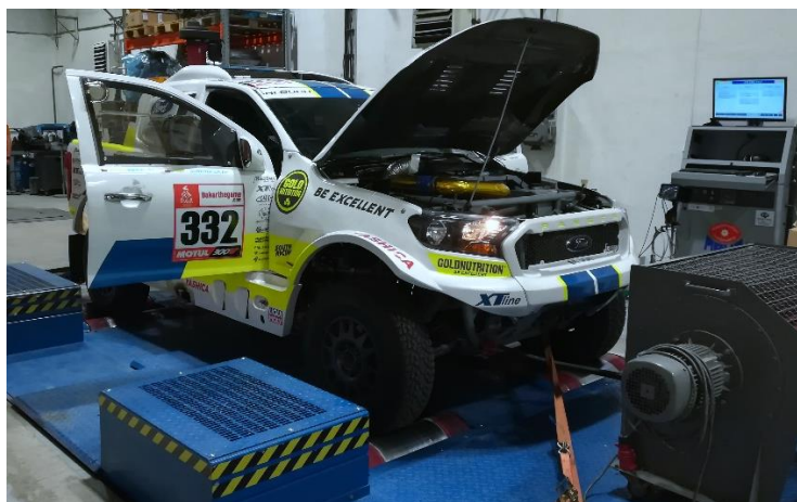
Obr. 16 Měření výkonu závodního vozidla na válcovém dynamometru
