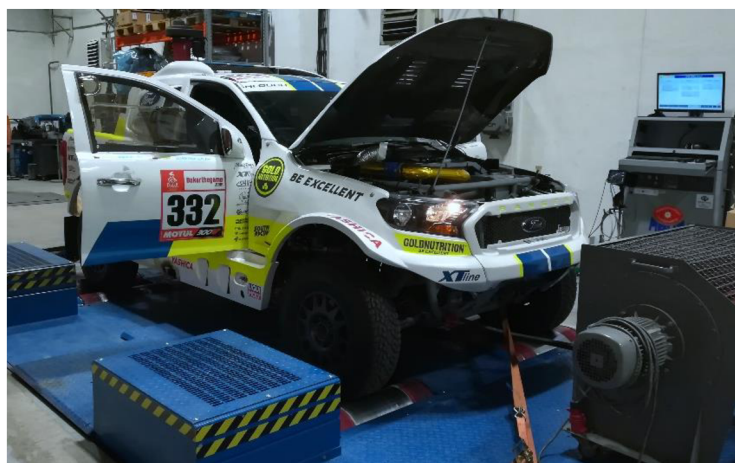
Obr. 16 Měření výkonu závodního vozidla na válcovém dynamometru
