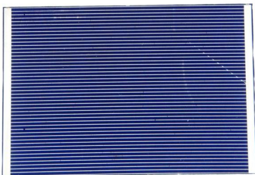
Obrázek 29 FV článek rozměru 72×48 mm
