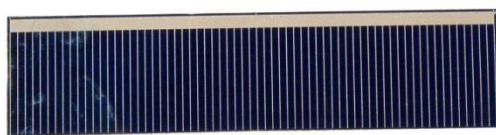
Obrázek 31 FV článek rozměru 16×60 mm
