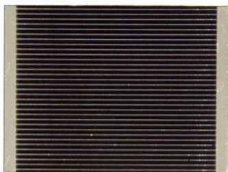
Obrázek 30 FV článek rozměru 27×20 mm
