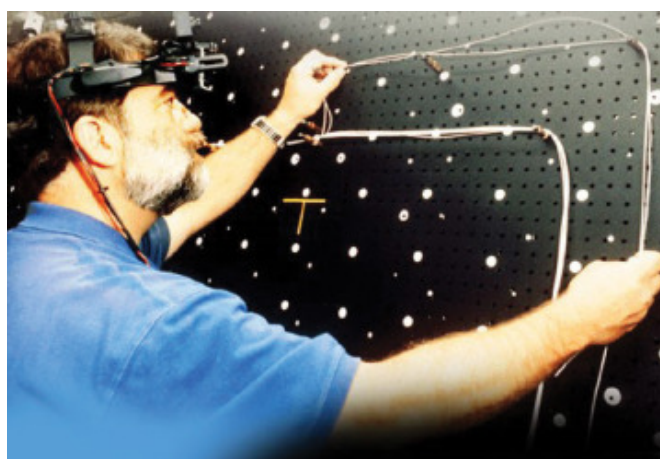
Obrázek 1.6: Prototyp HMD vytvořeného v Boeingu pro usnadnění elektroinstalací v letadlech. Převzato z [18].
