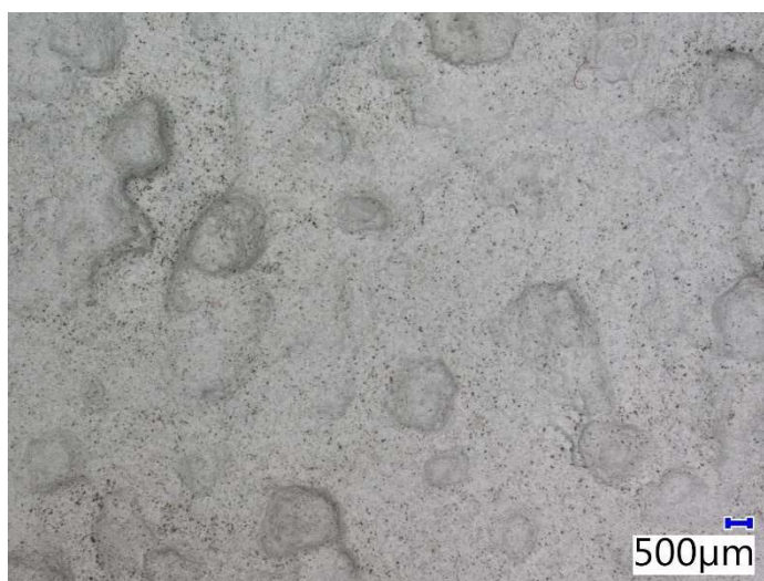
Obr. č. 49 - Snímek vzorku zašpiněného vlivem mechanického ulpívání, zvětšeno 20x
