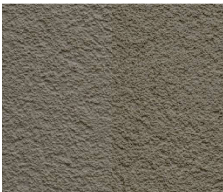
Obr. č. 55 - Omítka B1S - 1 po expozici přirozenému prostředí (vlevo referenční vzorek)
