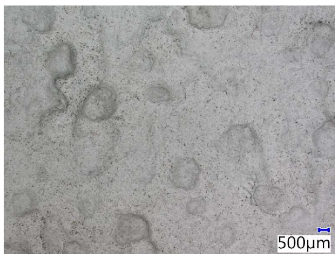
Obr. č. 49 - Snímek vzorku zašpiněného vlivem mechanického ulpívání, zvětšeno 20x
