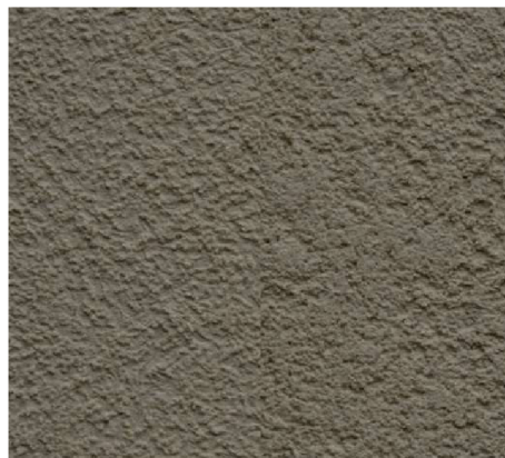
Obr č. 52 - Omítka A2PO -1 po expozici přirozenému prostředí (vlevo referenční vzorek)
