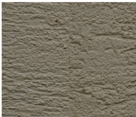
Obr. č. 66 - Omítka F1S - 1 po expozici přirozenému prostředí (vlevo referenční vzorek)
