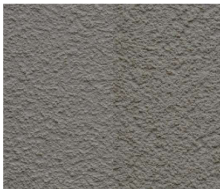
Obr. č. 59 - Omítka C2PO - 2 po expozici přirozenému prostředí (vlevo referenční vzorek)
