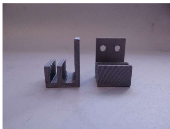
Obr. č. 26 – Systém upevnění vzorků
