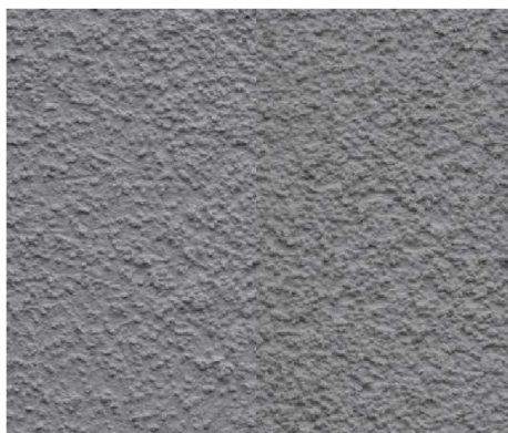
Obr. č. 64 - Omítka E1S - 1 po expozici přirozenému prostředí (vlevo referenční vzorek)
