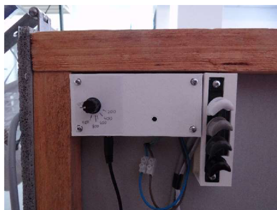
Obr. č. 28 – Regulátor velikosti napětí (vlevo) ovládání ventilátoru (vpravo)
