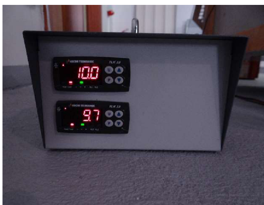
Obr. č. 27 – Regulátor teplot na chladících deskách
