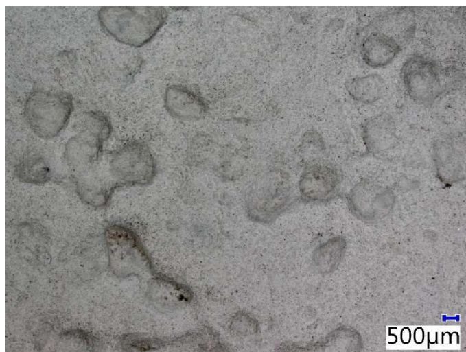
Obr. č. 48 - Snímek vzorku zašpiněného vlivem elektrostatických sil, zvětšeno 20x
