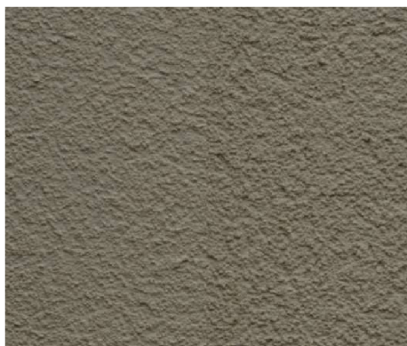
Obr. č. 61 - Omítka D1S - 1 po expozici přirozenému prostředí (vlevo referenční vzorek)
