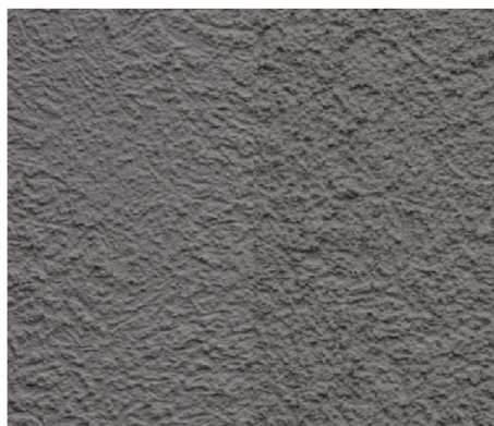
Obr. č. 65 - Omítka E2SO - 1 po expozici přirozenému prostředí (vlevo referenční vzorek)
