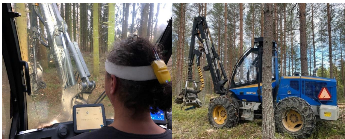
Obrázek 18 Vlevo: Měření při práci; Vpravo: harvestor Rottne H8
