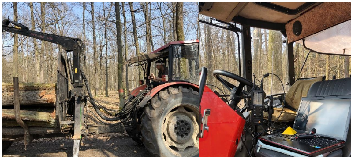
Obrázek 21 Vlevo: Sběr dat při práci; Vpravo: Měřicí přístroje ve vyvážecí soupravě
