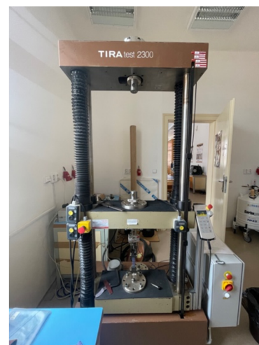
Obrázek 17 - Trhací zařízení TIRA test 2300
