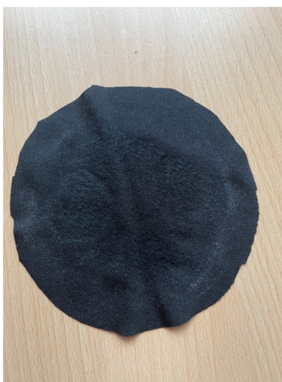
Obrázek 34 - Oděr o koberec
