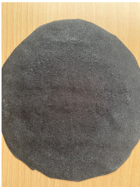
Obrázek 31 - Oděr o stejný materiál
