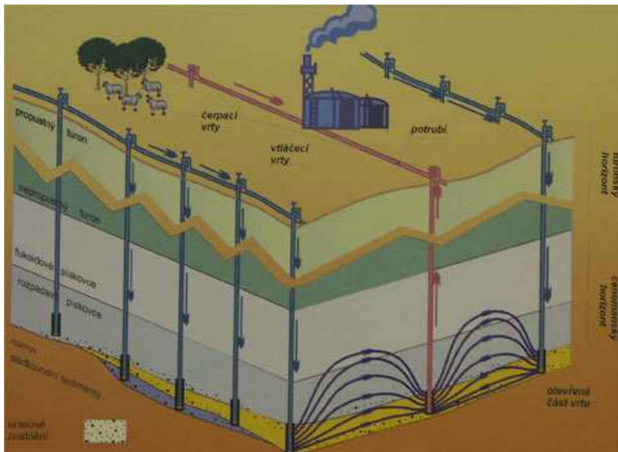
Obr. 2.3 Zjednodušený model metody loužení in-situ
