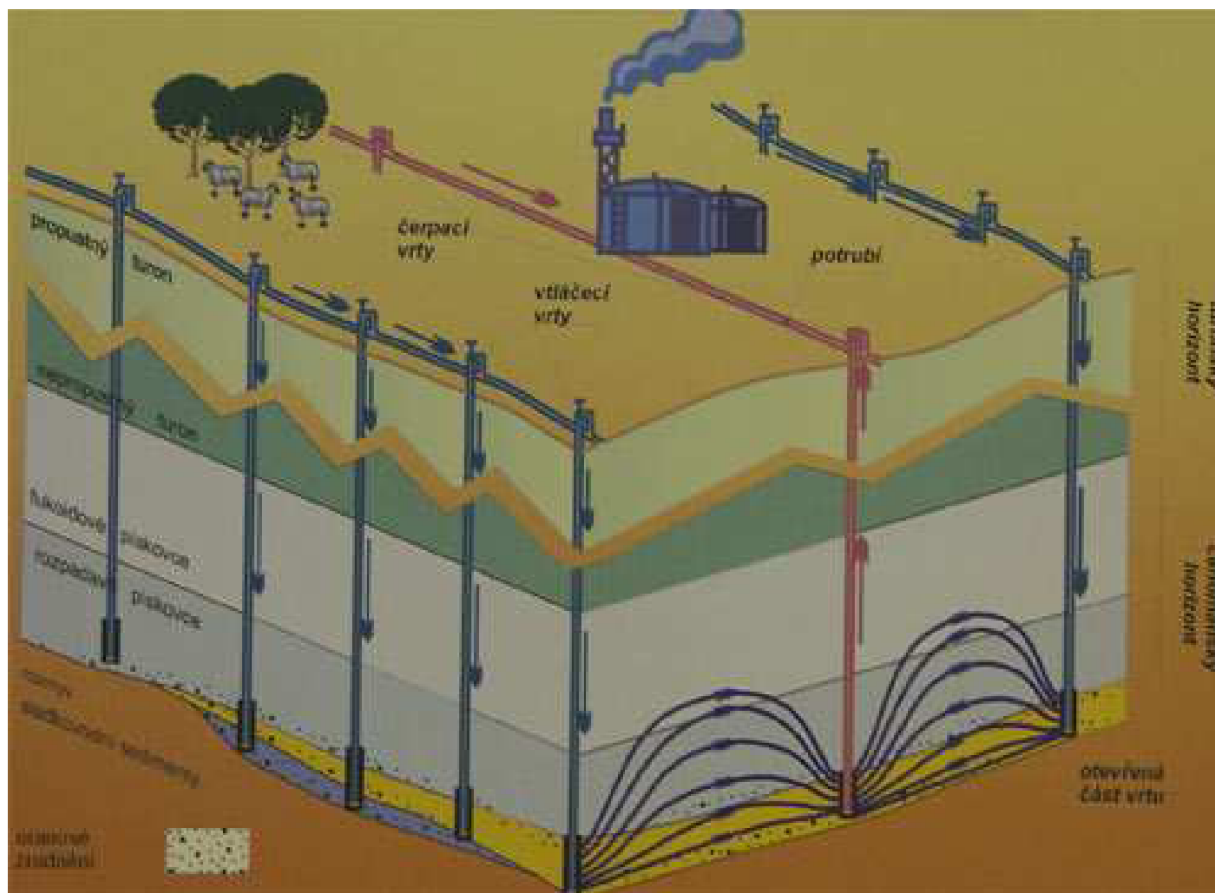
Obr. 2.3 Zjednodušený model metody loužení in-situ
