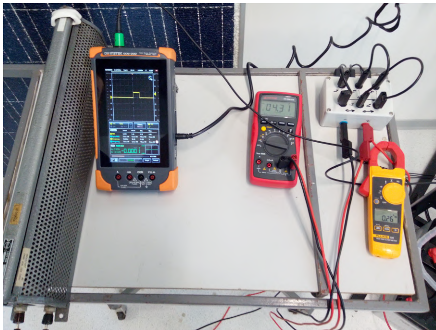
Obr. 2.4: Zapojení pracoviště pro měření charakteristik větrné turbíny
