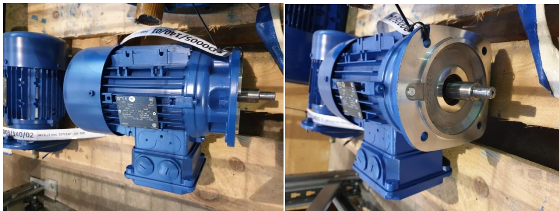
Obrázek č. 6: Elektromotor s upravenou hřídelí a speciální přírubou
