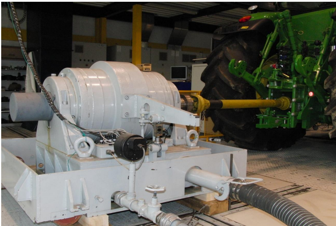
Obr. 11: Elektromagnetický vířivý dynamometr V-500 (foto: Polcar, Adam)
