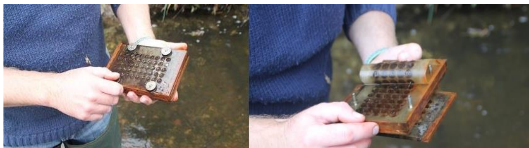
Obr. 13: Bioindikační destička dle Buddensika, vpravo je vidět filtrační tkanina, která propouští detritové částice menší než 40 \mu\text{m} (NIEDLOVÁ, 2014).
