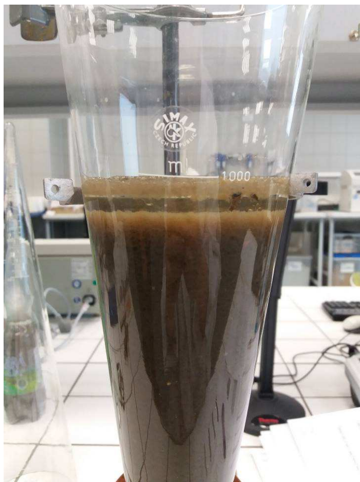
Obrázek 27: Sedimentace kalu po 30. minutách
