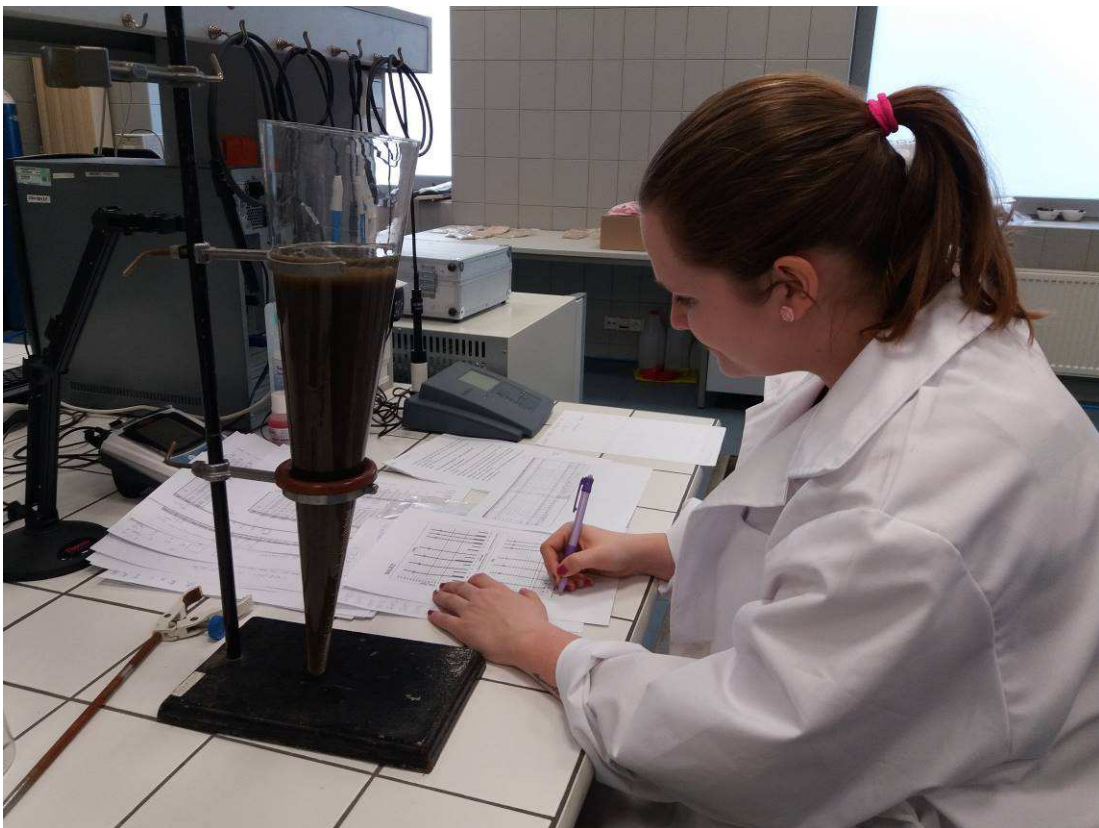
Obrázek 26: Sedimentace kalu – 30 minut
