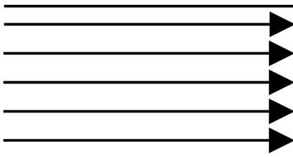
Obr. 4.2: Laminární proudění v uzavřeném kanálu.
