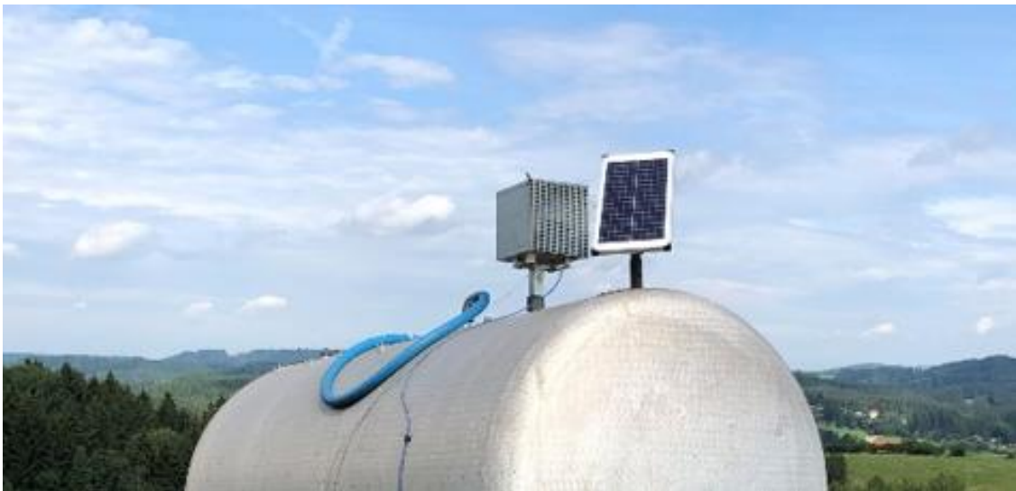
Obrázek 13: Ilustrační umístění zdroje se solárním panelem (zdroj: KULHÁNEK,2021 - archiv autora)
