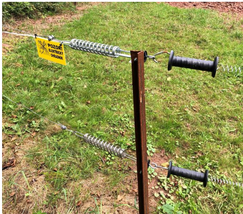
Obrázek 7: Nevodivá rukojeť u pružinové brány (zdroj: KULHÁNEK, 2021 - archiv autora)
