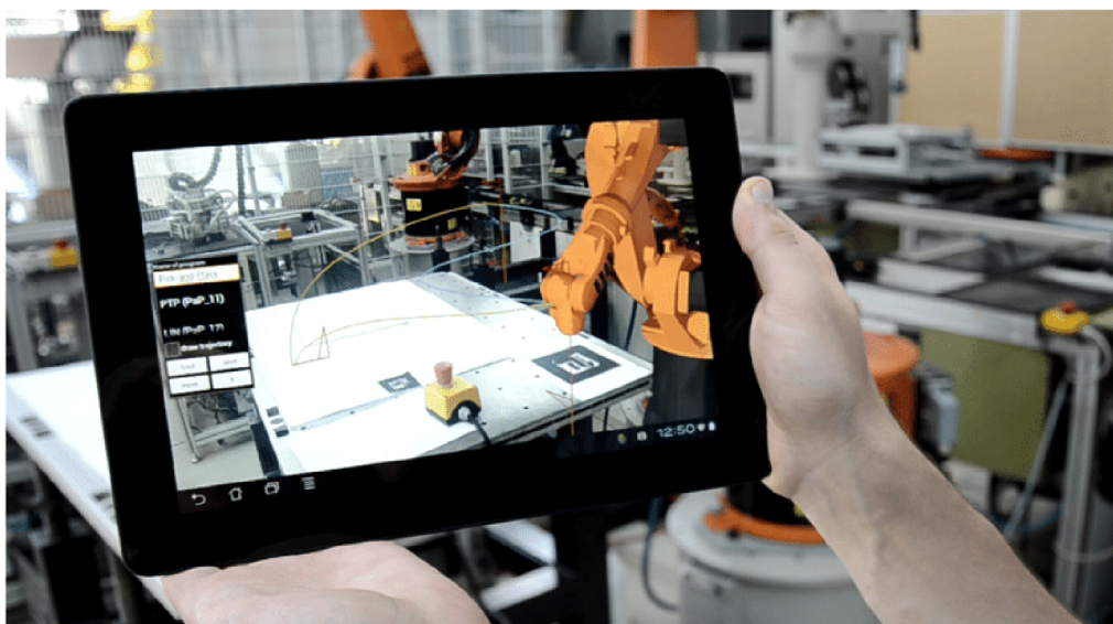
Obr. 2.10: Aplikácia v tablete využívajúca rozšírenú realitu v priemyselnom prostredí pre programovanie robotického pracoviska [19].
