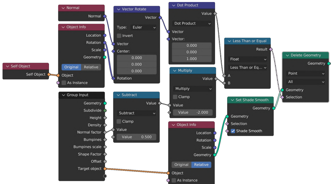
Obr. 4.2: Strom uzlov, pomocou ktorých sú získané plochy, pre ktoré je vygenerovaný sneh. Výsledkom je kópia geometrie plôch, ktoré sú ďalej spracované. Vrchná časť uzlov zabezpečuje rovnakú rotáciu aj v prípade, keď je objekt, z ktorého je generovaný sneh zrotovaný.
