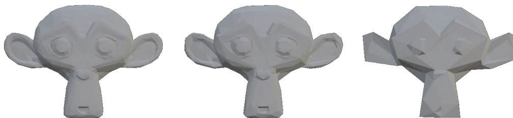
Obr. 2.2: V smere zľava doprava je možné vidieť, ako objekty ďalej od kamery postupne strácajú na definícii pôvodnej geometrie, tvorí ich menší počet detailov a polygónov, čo zároveň znižuje výpočtovú náročnosť objektu.
