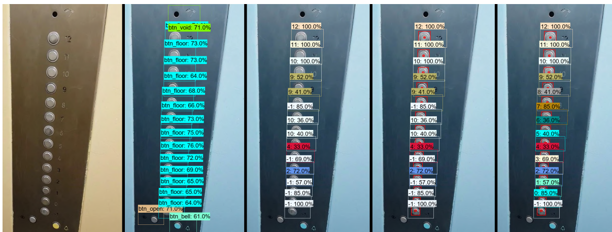
Obrázek 6.11: Sekvence obrazů vizualizace fází algoritmu automatické detekce ovládacích prvků výtahu, postupně zleva doprava: originální obraz vstupu, detekce ovládacích prvků, klasifikace ovládacích volby podlaží, nalezení akčních částí ovládacích volby podlaží, přeznačení sekvence čísel
