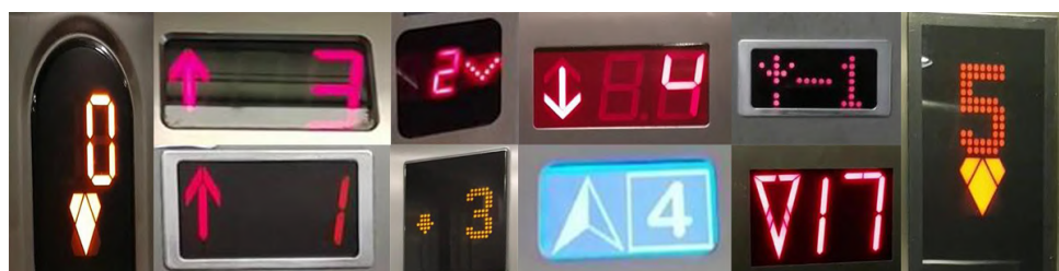
Obrázek 4.5: Ukázka typů displejů aktuálního podlaží výtahových zařízení
