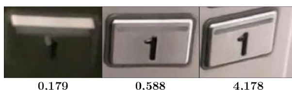
Obrázek 6.4: Vizualizace metriky kontroly rozostřenosti obrazu - detail na konkrétní ovládač volby podlaží v průběhu záznamu doplněný hodnotou metriky
