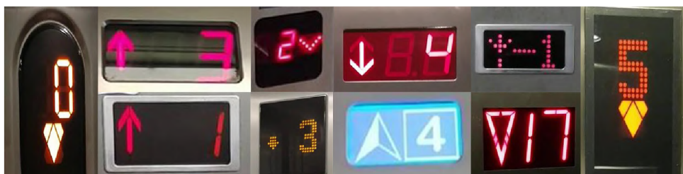
Obrázek 4.5: Ukázka typů displejů aktuálního podlaží výtahových zařízení
