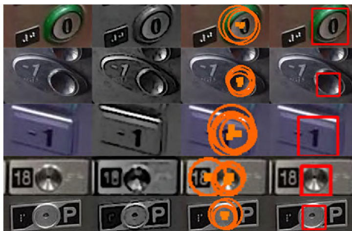
Obrázek 6.8: Vyhledávání akčních oblastí ovládačů volby podlaží výtahové kabiny, postupně zleva doprava: originální obraz ovládače z detekce prvků, převod na černobílý obraz a filtrování Unsharp Mask, nalezení kružnic v Houghově prostoru, detekovaná akční část ovládače
