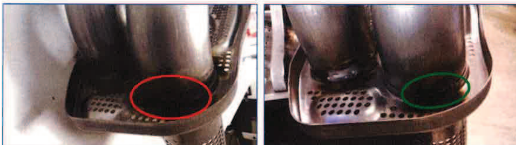
Obrázek 23: Příklad nadbytečného sváření (vlevo) a dostačující délky svaru dle specifikace zákazníka (vpravo) [5]
