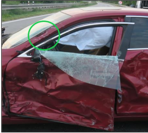
Obr. č. 30 – Poškození vozidla Lexus v úrovni levého zpětného zrcátka [52]
