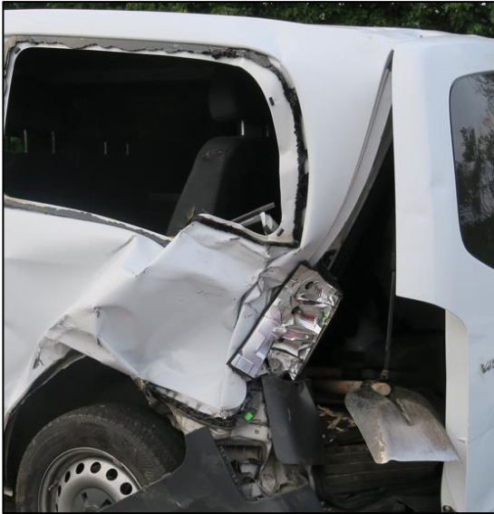
Obr. č. 29 – Poškození levého zadního rohu vozidla Mercedes Vito [52]
