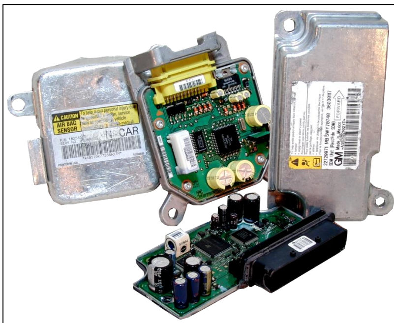
Obr. č. 1 – Airbag Control Module (ACM) [3]
