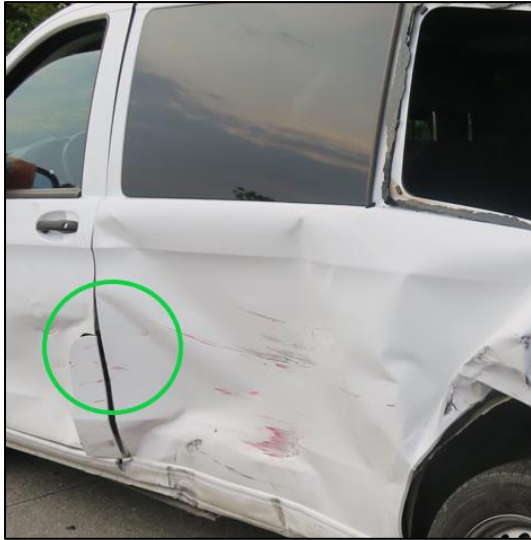
Obr. č. 31 – Poškození levého boku vozidla Mercedes Vito [52]
