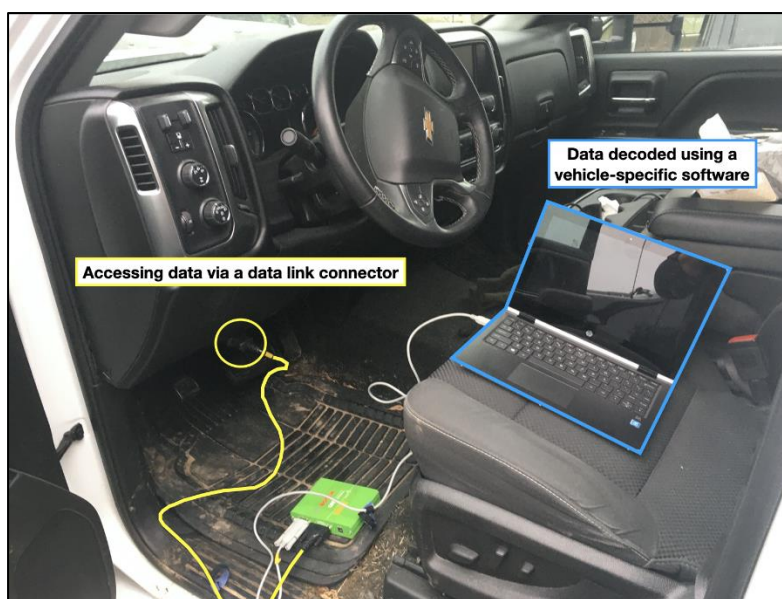
Obr. č. 3 – Metoda připojení pomocí diagnostického portu [28]
