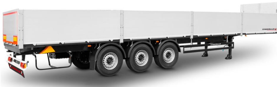
Obr. 36 [Schwarzmüller 3 nápravový valníkový návěs pro stavební materiál]
