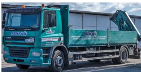
Obr. 27 [Nákladní vozidlo s hydraulickou rukou DAF AE 85XF]
