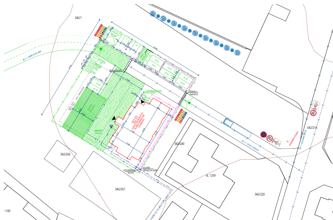
Obr. 55 [Koncept zařízení staveniště]
