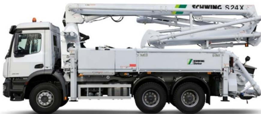
Obr. 34 [Čerpadlo betonu – Schwing S24 X]
