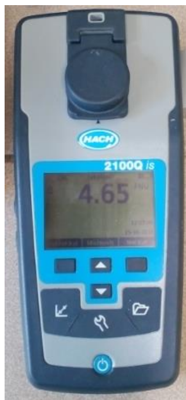
Obr. 8.20 Přenosný turbidimetr [autor]
