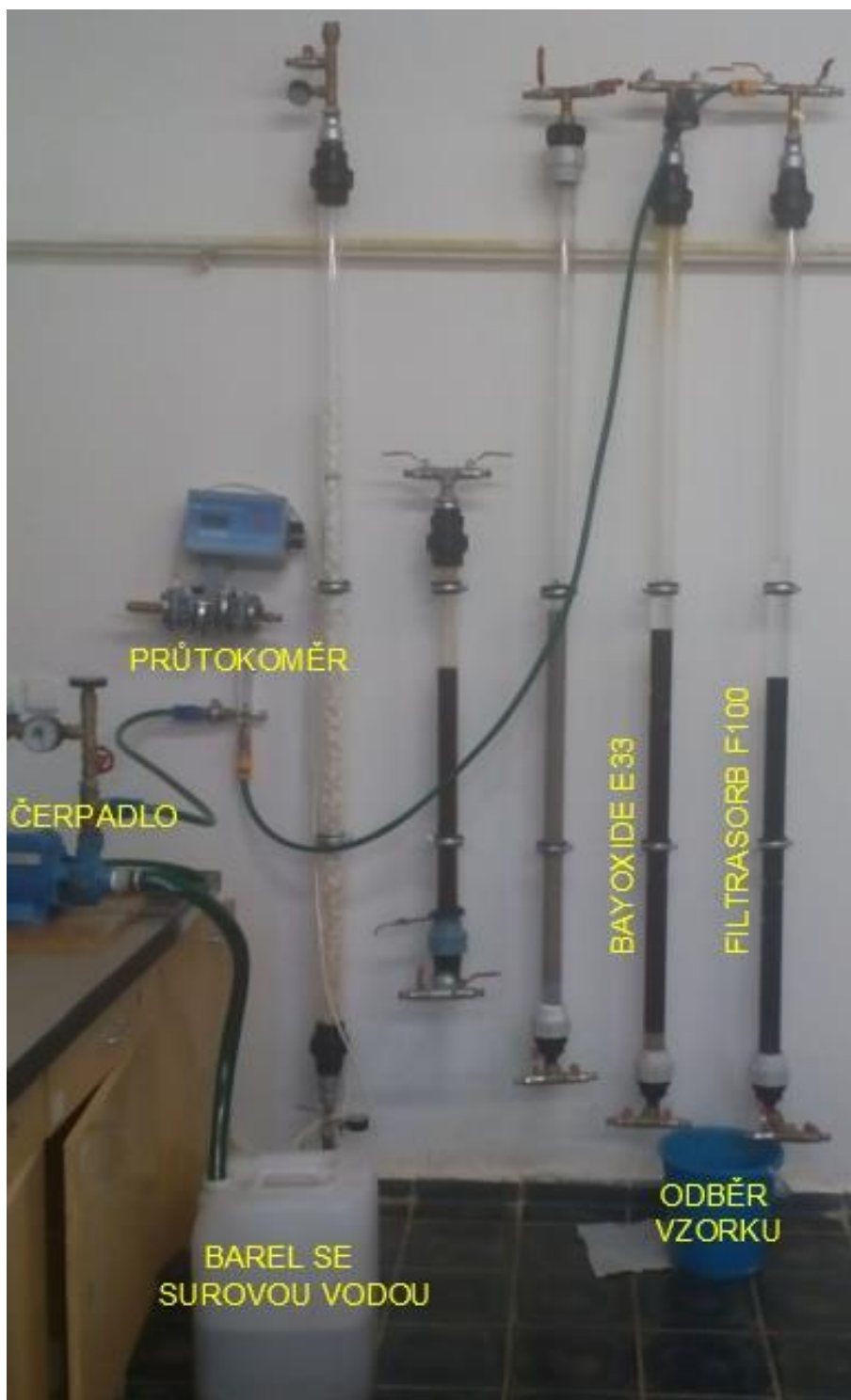
Obr. 8.23 Reálná podoba filtračního zařízení [autor]
