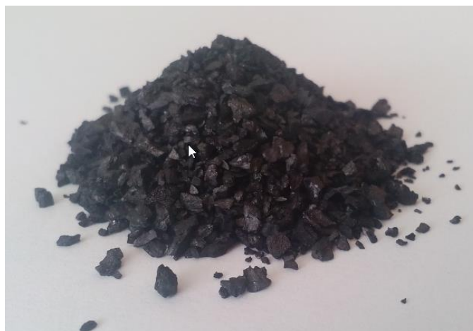
Obr. 8.15 Filtrační materiál Filtrasorb F100 [autor]
