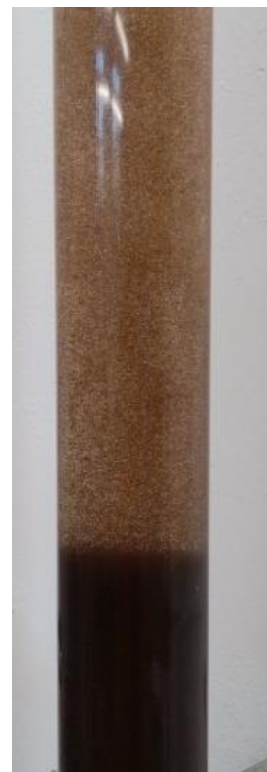
Obr. 8.18 Prání sorpčního materiálu Bayoxid E33 [autor]
