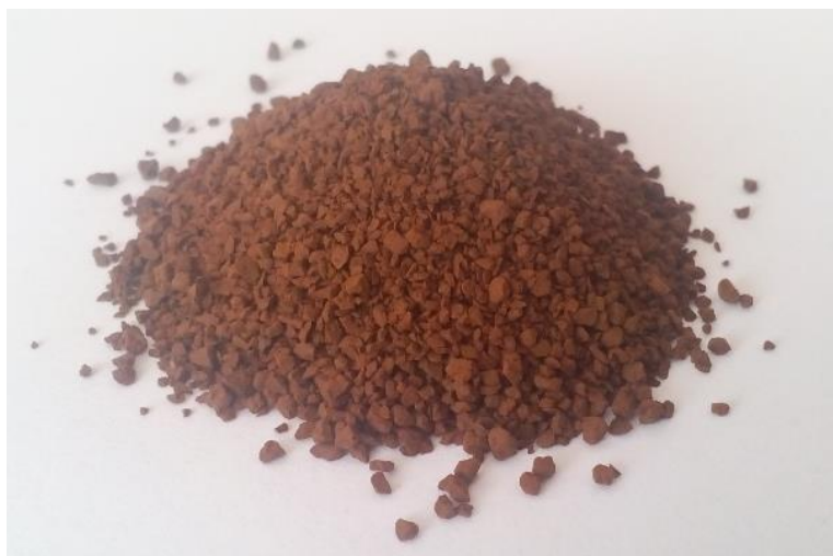
Obr. 8.16 Filtrační materiál Bayoxide E33 [autor]
