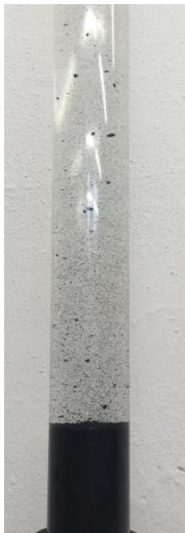
Obr. 8.17 Prání sorpčního materiálu Filtrasorb F100 [autor]
