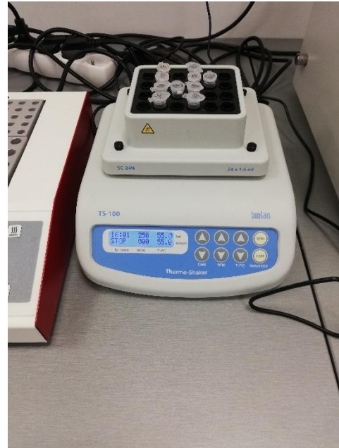
Obrázek 4: Průběh izolace DNA; inkubátor pro izolaci DNA
