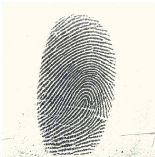
Obr. 4.12: Prasklina na snímači optického senzora na snímke odtlačku prsta (čierne tenké čiary pri rohoch). Prevzaté z [27].
